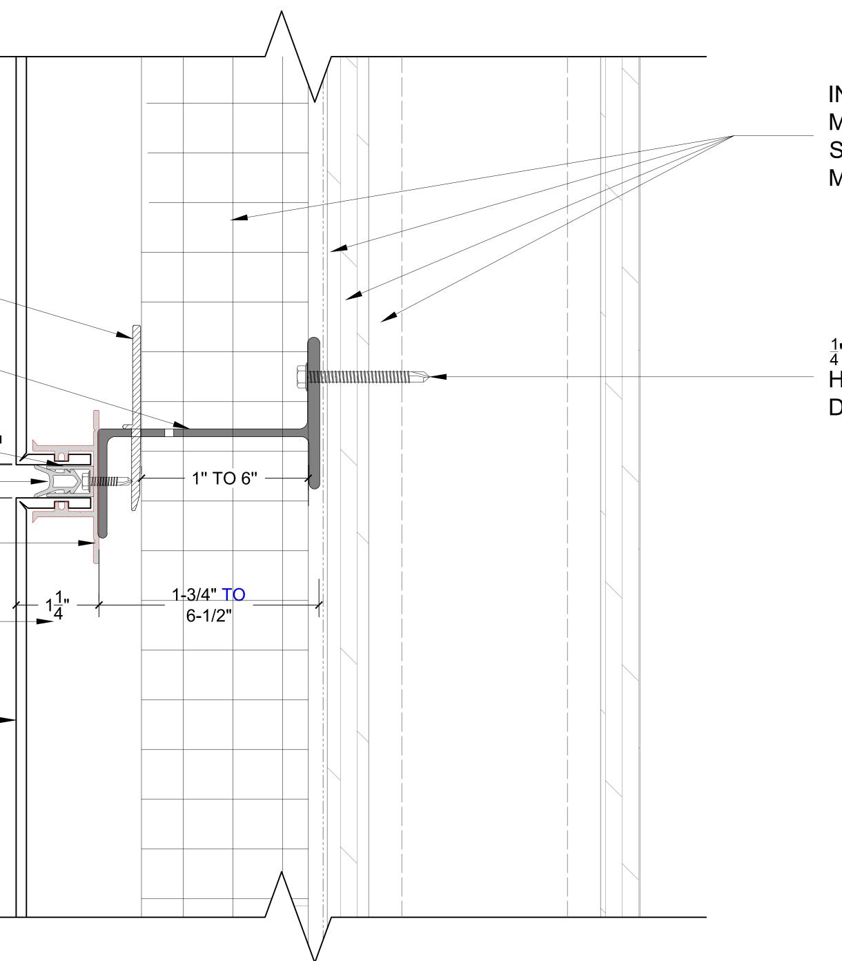
INSULATION MOISTURE BARRIER SHEATHING METAL STUD WALL
